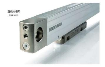
X、Z轴直线电机,具有超高推力密度,低顿力,配有海德汉全闭环高精度直线光栅尺,直线光栅尺具有测量方向上的高刚性,热特性好等特点,全闭环控制模式能消除潜在的多个误差源,从而保证了机床高精度定位和高速加工时的稳定性,且长期持久。Y轴采用高扭矩输出NUM伺服电机,可配直线轴光栅尺。
